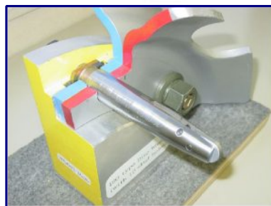
ホイールを装着し、2~3箇所ナットを締め付けます
